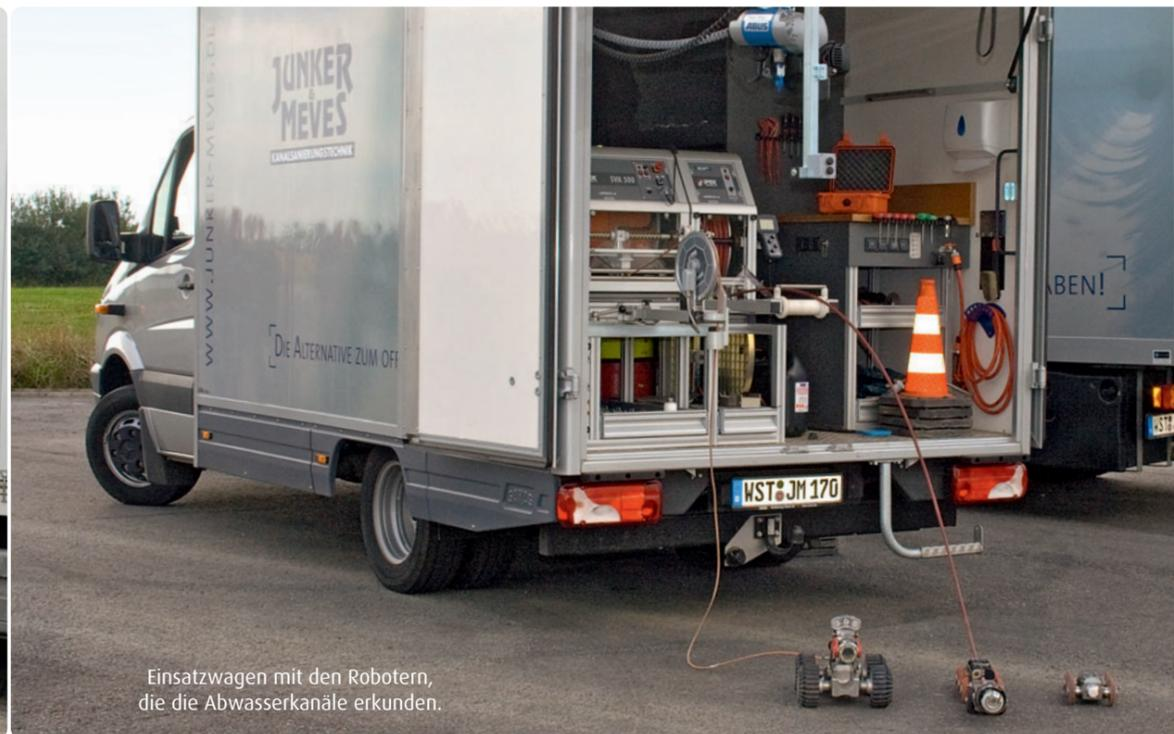
Einsatzwagen mit den Robotern, die die Abwasserkanäle erkunden.
